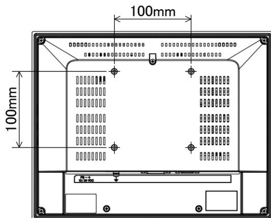
M4 のネジで固定します。締付けトルクは 0.7~0.8N・m です。
