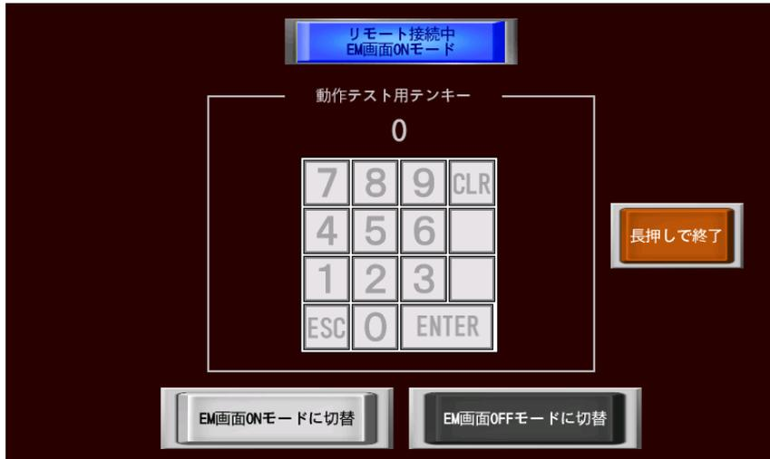
中央の動作テスト用テンキーで、外部機器の入力が EM 本体側に反映されることを確認頂けます。
